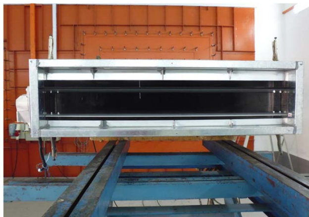
壓損測試 風速: 20.019 m/s
