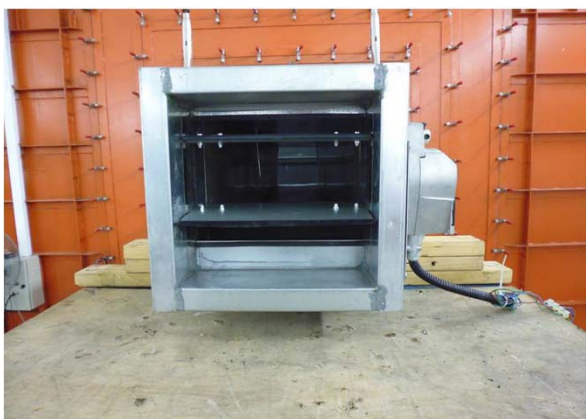
壓損測試 風速: 20.019 m/s
