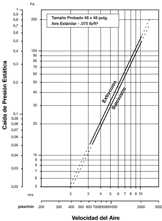
La resistencia del modelo ESD-401SM al flujo del aire (caída de presión) varía dependiendo de la aplicación del louver (extracción o suministro de aire). En el diagrama se muestra que las velocidades del aire son mayores que las velocidades normales sobre los tamaños del louver. Revise la información del louver.
