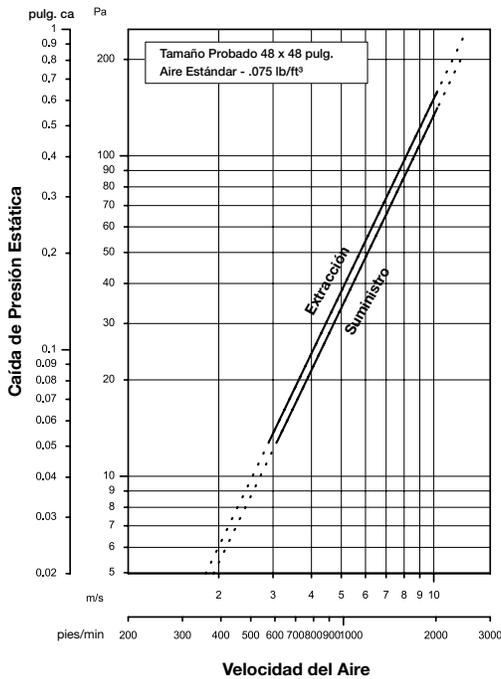
La resistencia del modelo EAD-401SM al flujo del aire (caída de presión) varía dependiendo de la aplicación del louver (extracción o suministro de aire). En el diagrama se muestra que las velocidades del aire son mayores que las velocidades normales sobre los tamaños del louver. Revise la información del louver.
