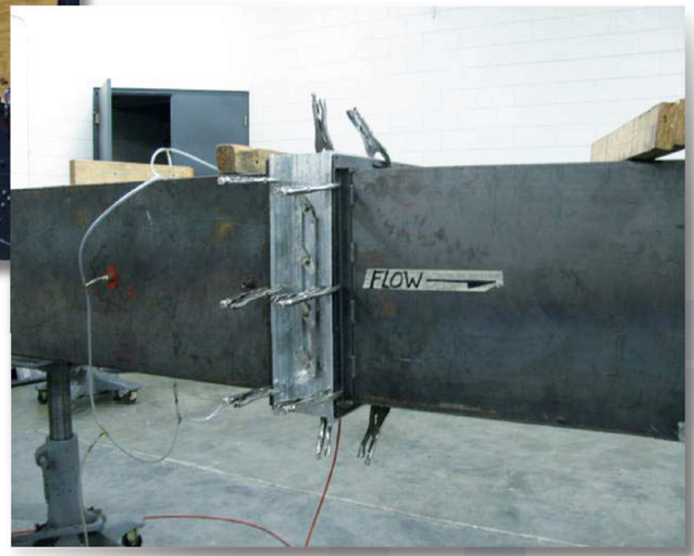
◆ Pressure drop test 壓損測試 Max Air Velocity 風速：20.2 m/s
