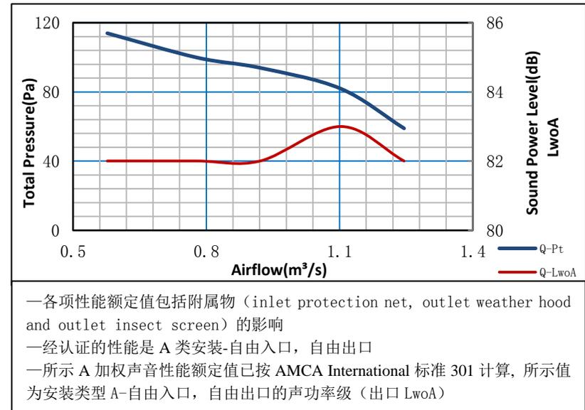
DFBZ-4.5 方型壁式轴流风机性能参数与曲线
