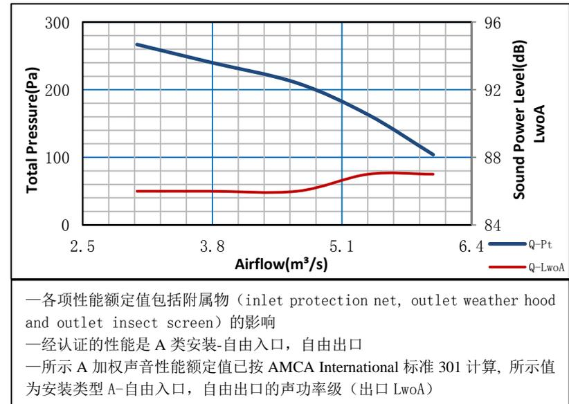
DFBZ-9.0 方型壁式轴流风机性能参数与曲线
