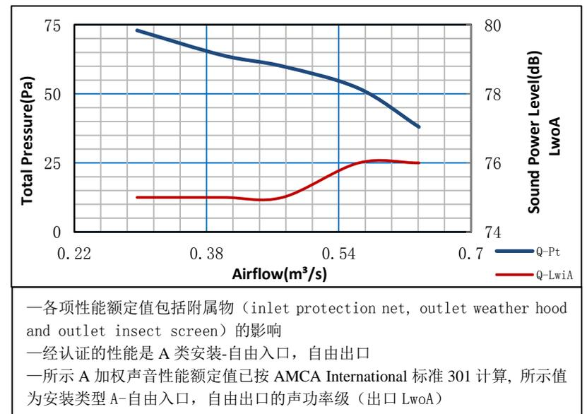
DFBZ-3.6 方型壁式轴流风机性能参数与曲线
