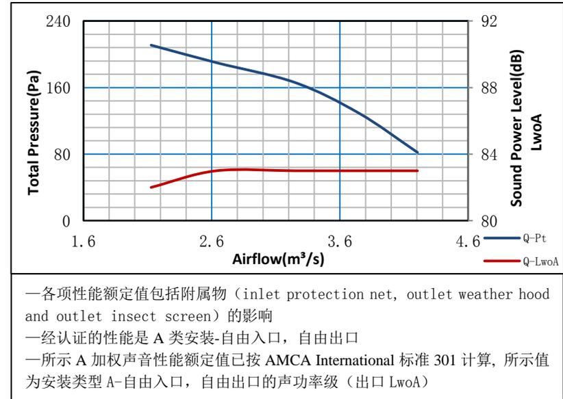
DFBZ-8.0 方型壁式轴流风机性能参数与曲线
