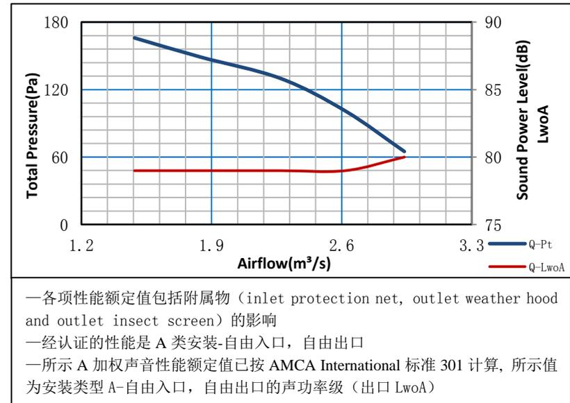
DFBZ-7.1 方型壁式轴流风机性能参数与曲线
