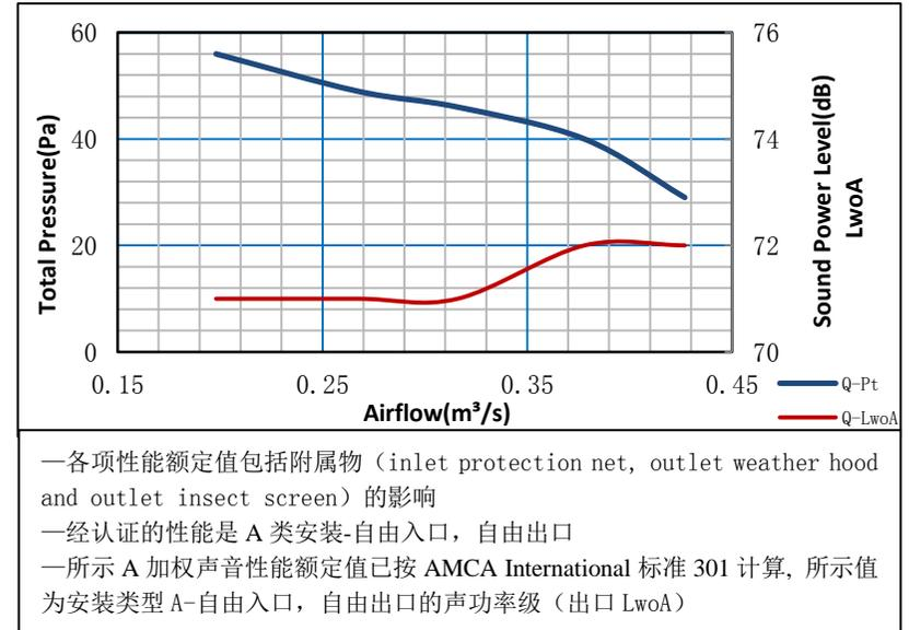
DFBZ-3.2 方型壁式轴流风机性能参数与曲线
