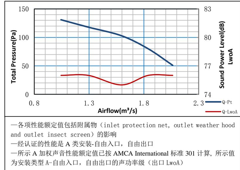
DFBZ-6.3 方型壁式轴流风机性能参数与曲线
