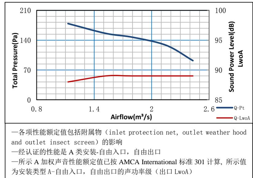
DFBZ-5.6 方型壁式轴流风机性能参数与曲线
