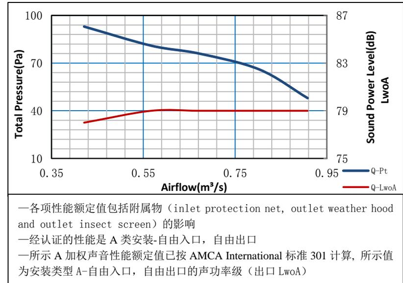
DFBZ-4.0 方型壁式轴流风机性能参数与曲线
