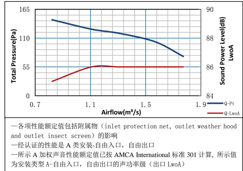
DFBZ-5.0 方型壁式轴流风机性能参数与曲线
