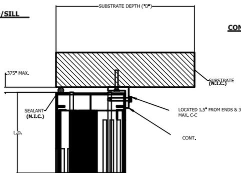
**REVERSE ANGLE INSTALLATION @ LOUVER HEAD/SILL**
