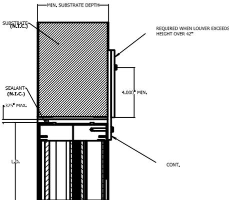
**FLAT PLATE INSTALLATION @ LOUVER HEAD/SILL**
