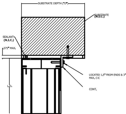
**CONTINUOUS ANGLE INSTALLATION @ LOUVER HEAD/SILL**
